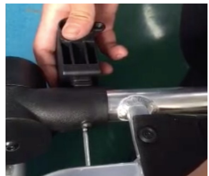
Stap 6: Zet de adapters weer goed vast en plaats de armleuningen terug.
