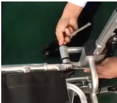
Stap 1: Zwenk de armleuningen naar achteren en demonteer deze van de rolstoel.
