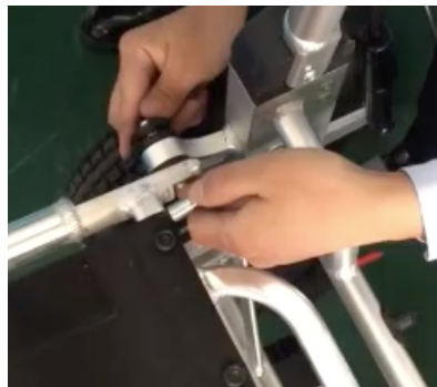
Stap 2: Vervang de rotatieassen en plaats per armleuning twee extra opvulringen.
