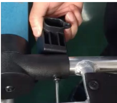
Stap 4: Demonteer de adapters voorop de zitbuis.
